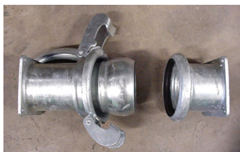
HAN-del med lås och MZ-fläns HON-del med gummipackning och MZ-fläns
